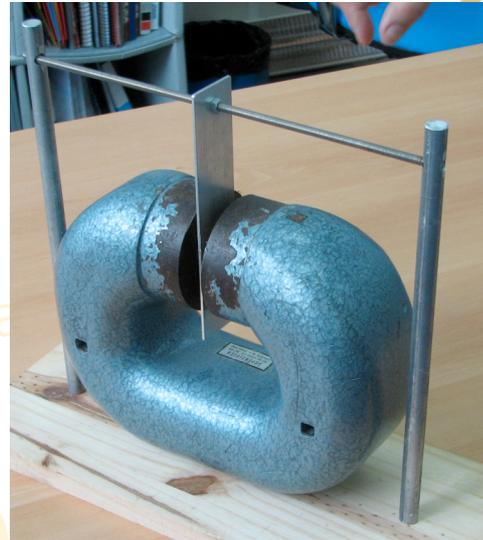
Figura 3: Funcionamiento de un freno magnético.
