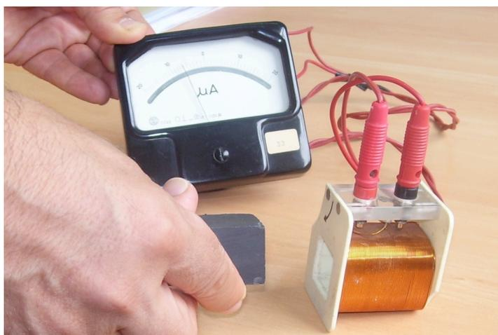
Figura 2: Montaje para observar el fenómeno de inducción electromagnética.
